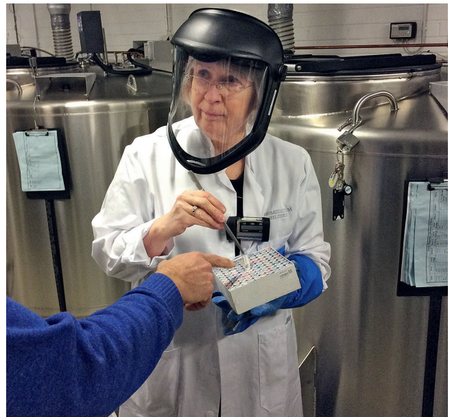
Manuelle Entnahme eines Probenracks aus gesichertem, – 180 Grad C kaltem Stickstofftank mit Sicherheitskleidung: Sicherheitsmaske, kältebeständige Schürze und Handschuhe, langärmeliger Mantel, Sicherheitsschuhe und tragbarer Sauerstoffsensor in der Nähe des Gesichts.
